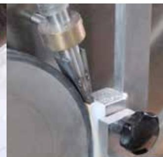
*Verschleißprüfungen nach der Sand-Slurry-Methode und dem Reibrad-Verfahren ermöglichen eine hervorragende Klassifizierung der Prüfkörper.*
